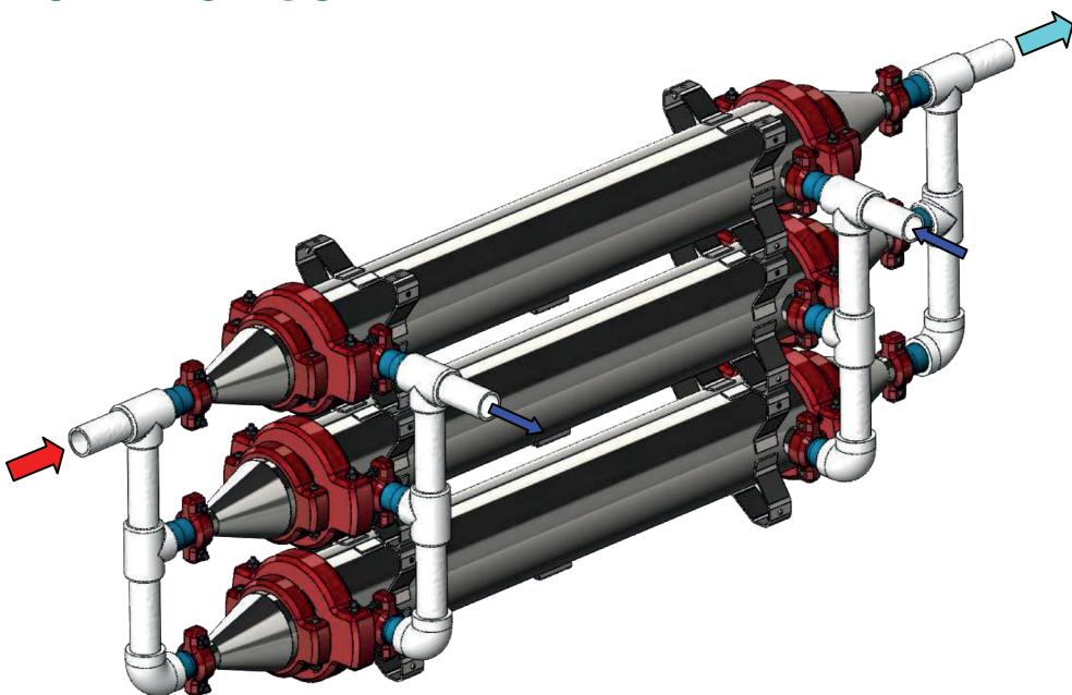
При параллельном подключении увеличивается расход и теплопередача в 2-3-4-5-6 раз (зависит от количества блоков).
